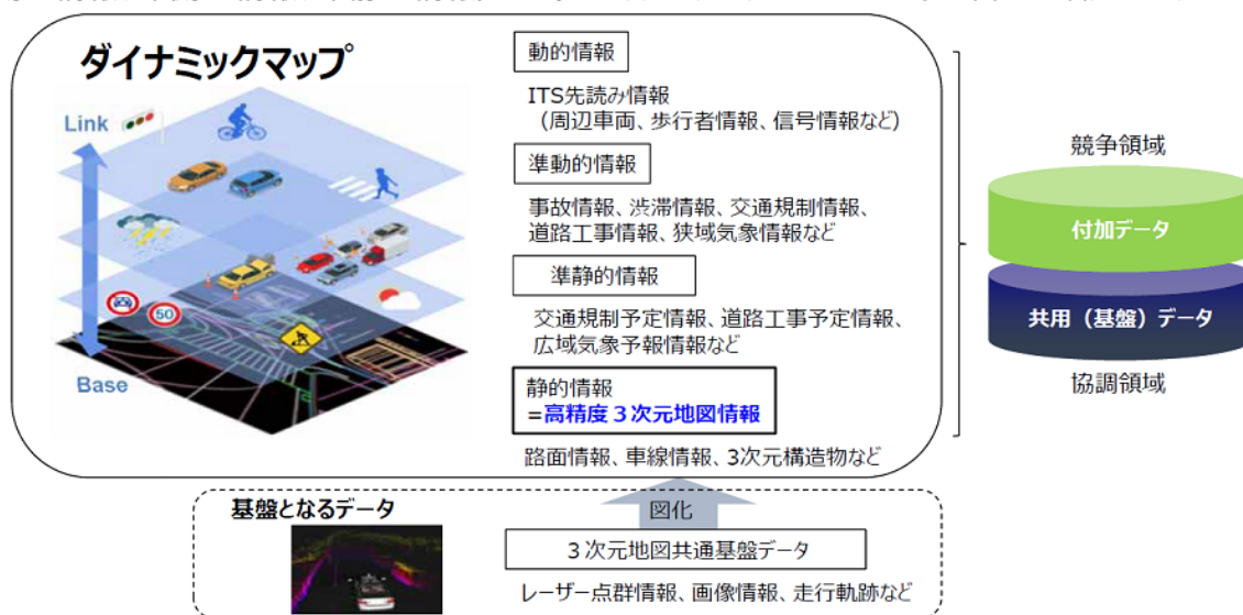
図 1.2-1 ダイナミックマップの構築イメージ[2]
