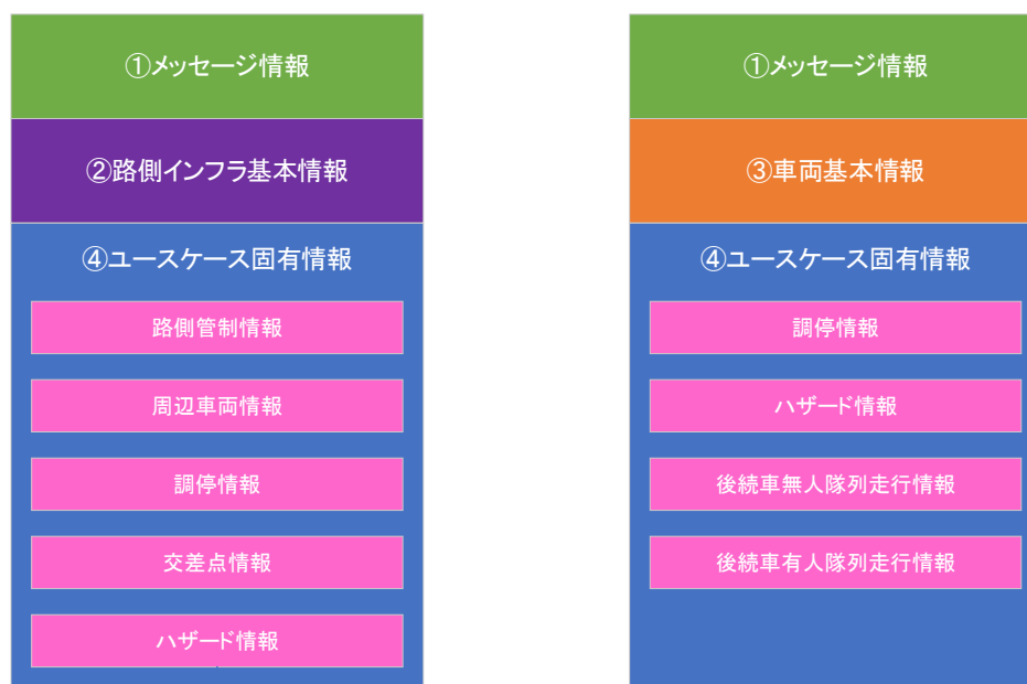
図 3-2 メッセージ構成例（左：路側インフラのメッセージ、右：車両のメッセージ）
