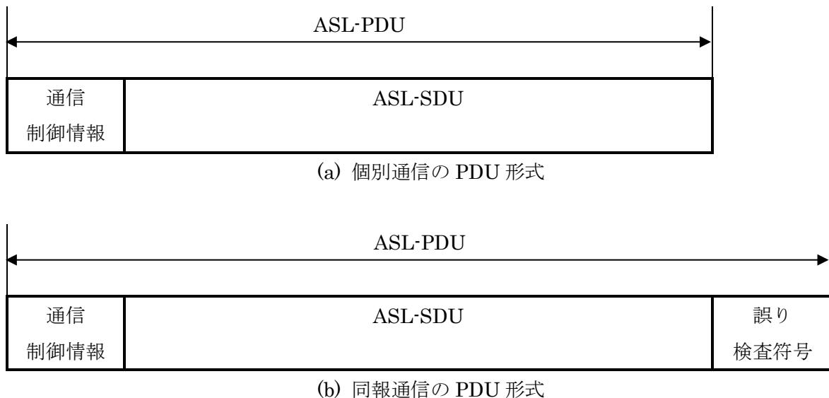
図 3.1-8 ASL-PDU の構成 (ARIB STD-T120)
