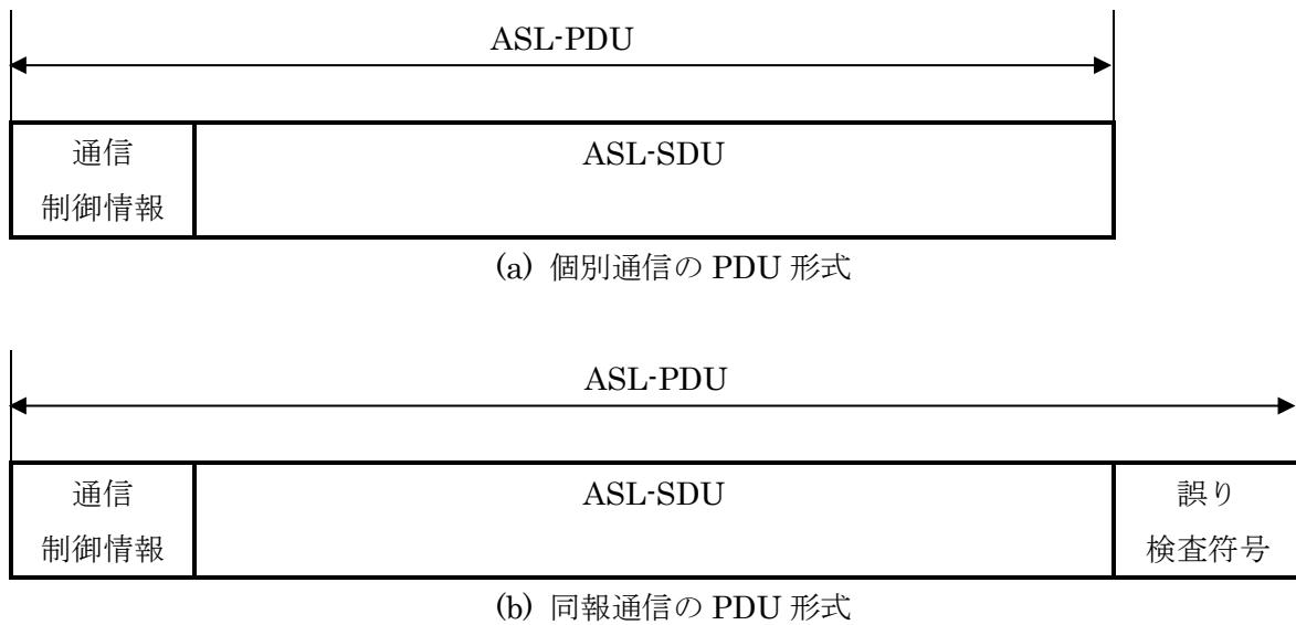
図 3.1-4 ASL-PDU の構成 (ITS FORUM RC-005)
