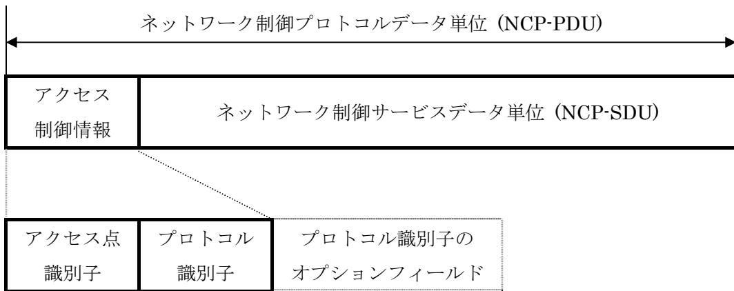
図 3.1-12 通信制御管理の PDU の構成
