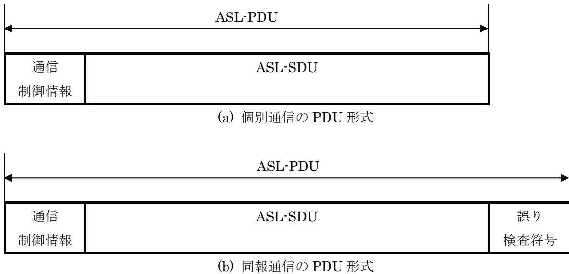
図 3.1-7 ASL-PDU の構成 (ARIB STD-T109)
