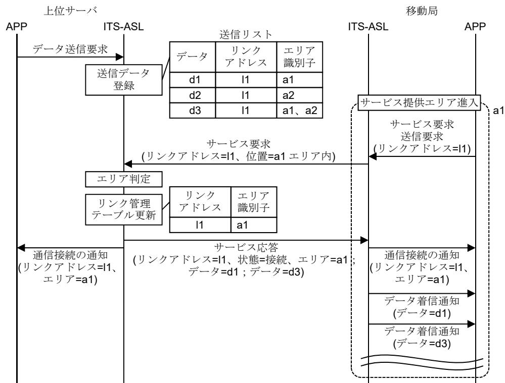
付図 D7-13 転送サービス処理手順の例（サービス提供エリアに進入）
