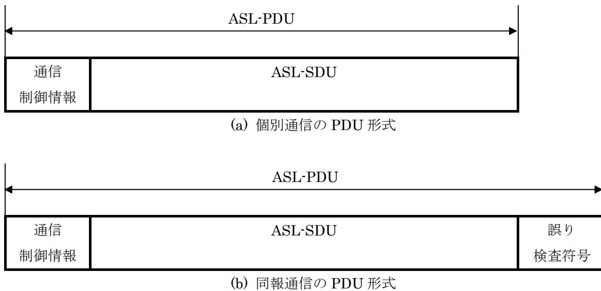
図 3.1-6 ASL-PDU の構成 (ARIB STD-T104)
