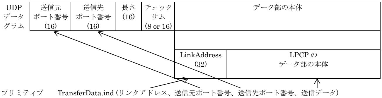
図 3.3-33 TransferData.ind における PDU マッピング
