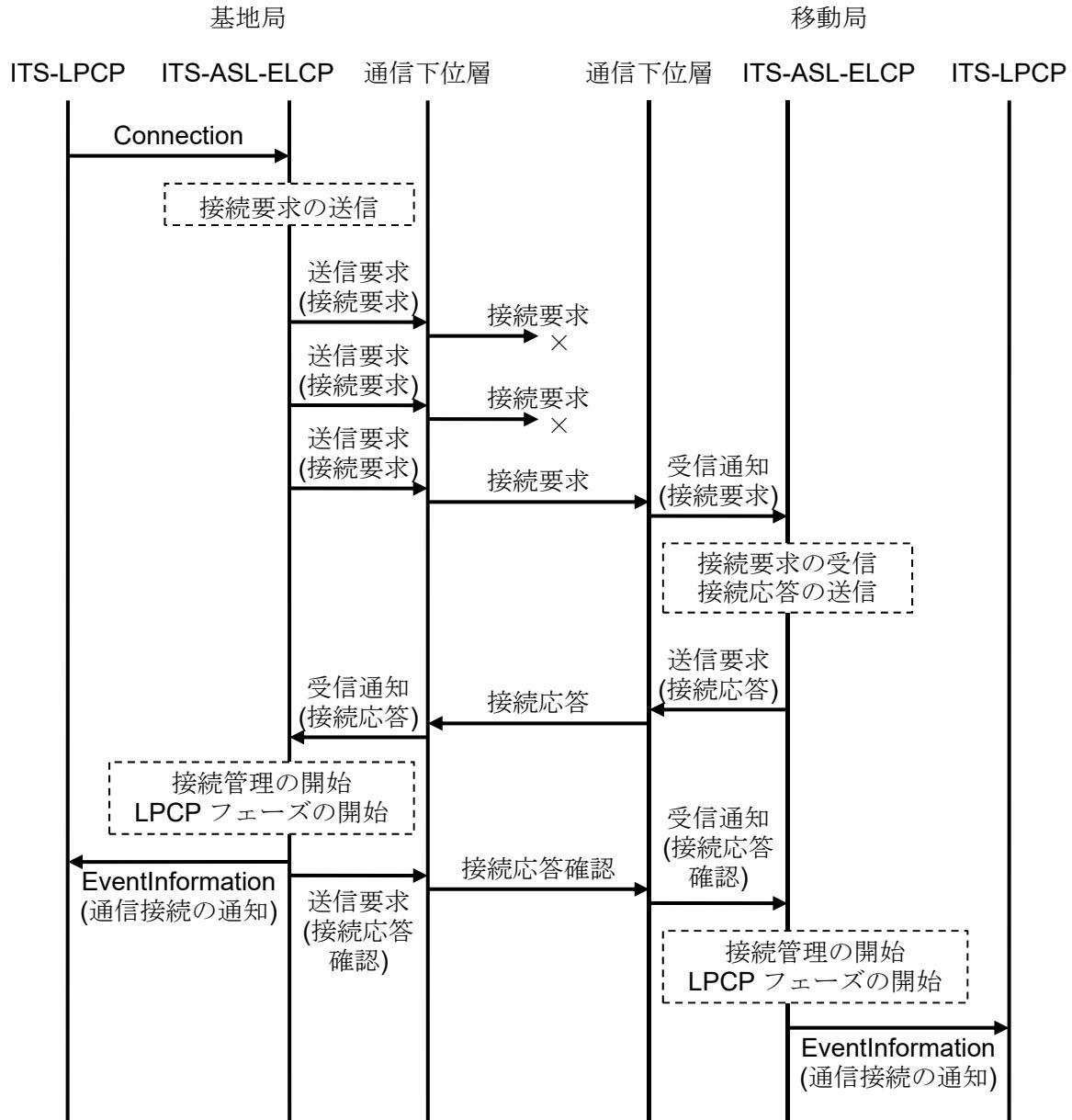
図 3.1-11 通信接続手順の例
