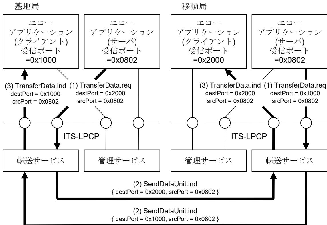
図 3.2-13 データ転送動作例 (エコー応答)
