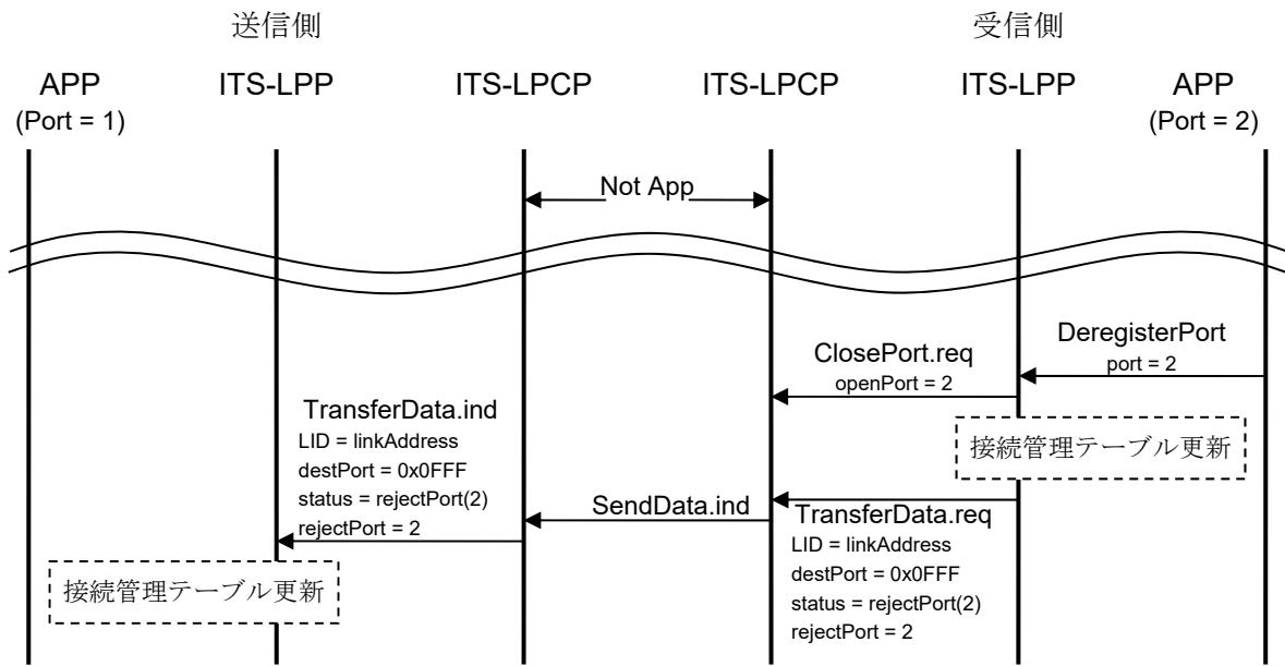
図 3.3-27 受信可能ポート削除手順の例
