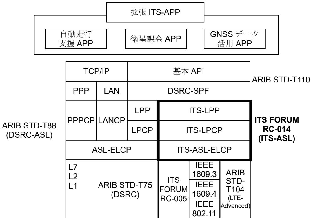
図 1.2-1 DSRC プラットフォーム（拡張）のプロトコル構成
