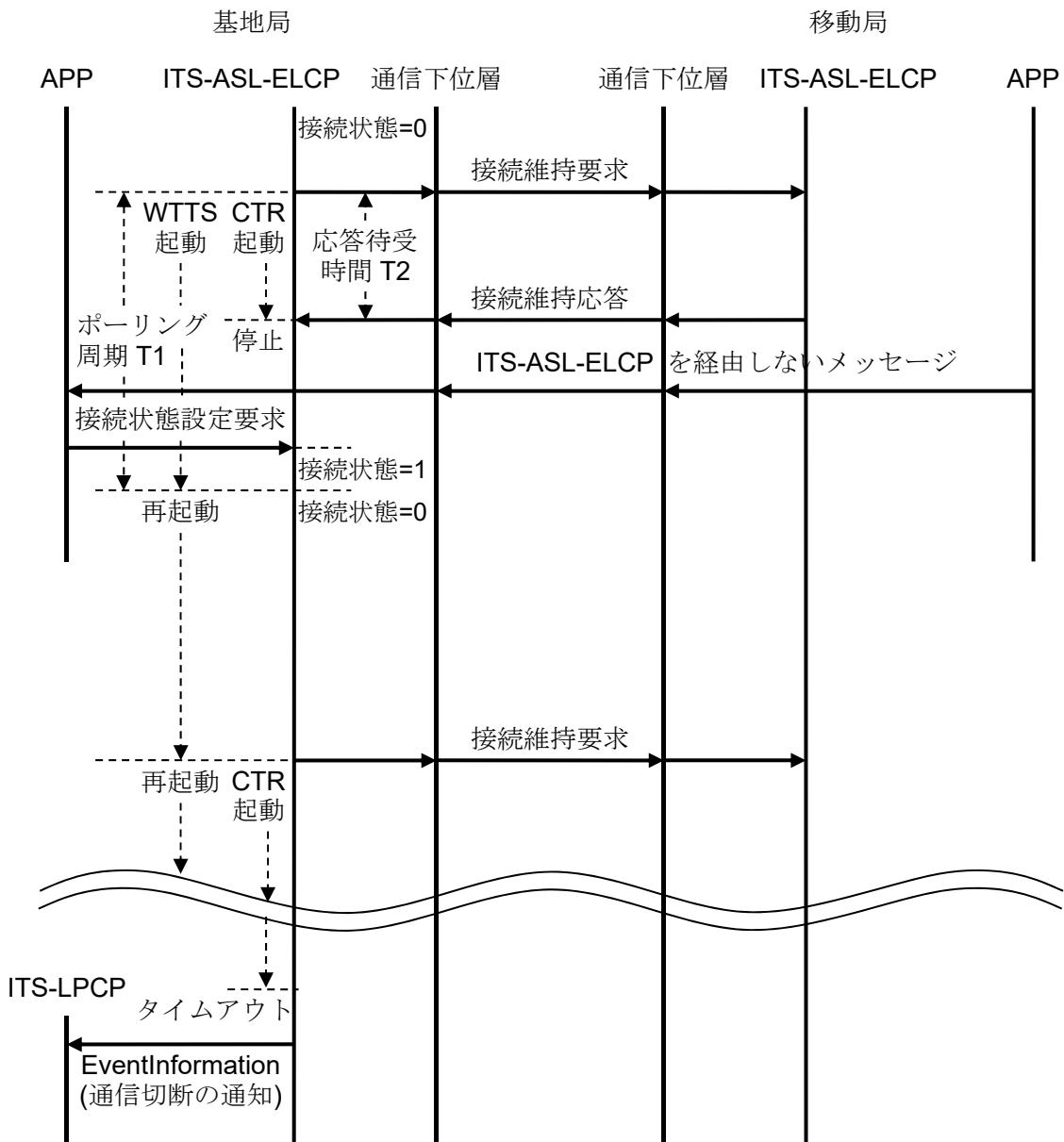
図 3.1-14 アプリケーションから接続状態を設定する通信接続管理手順の例
