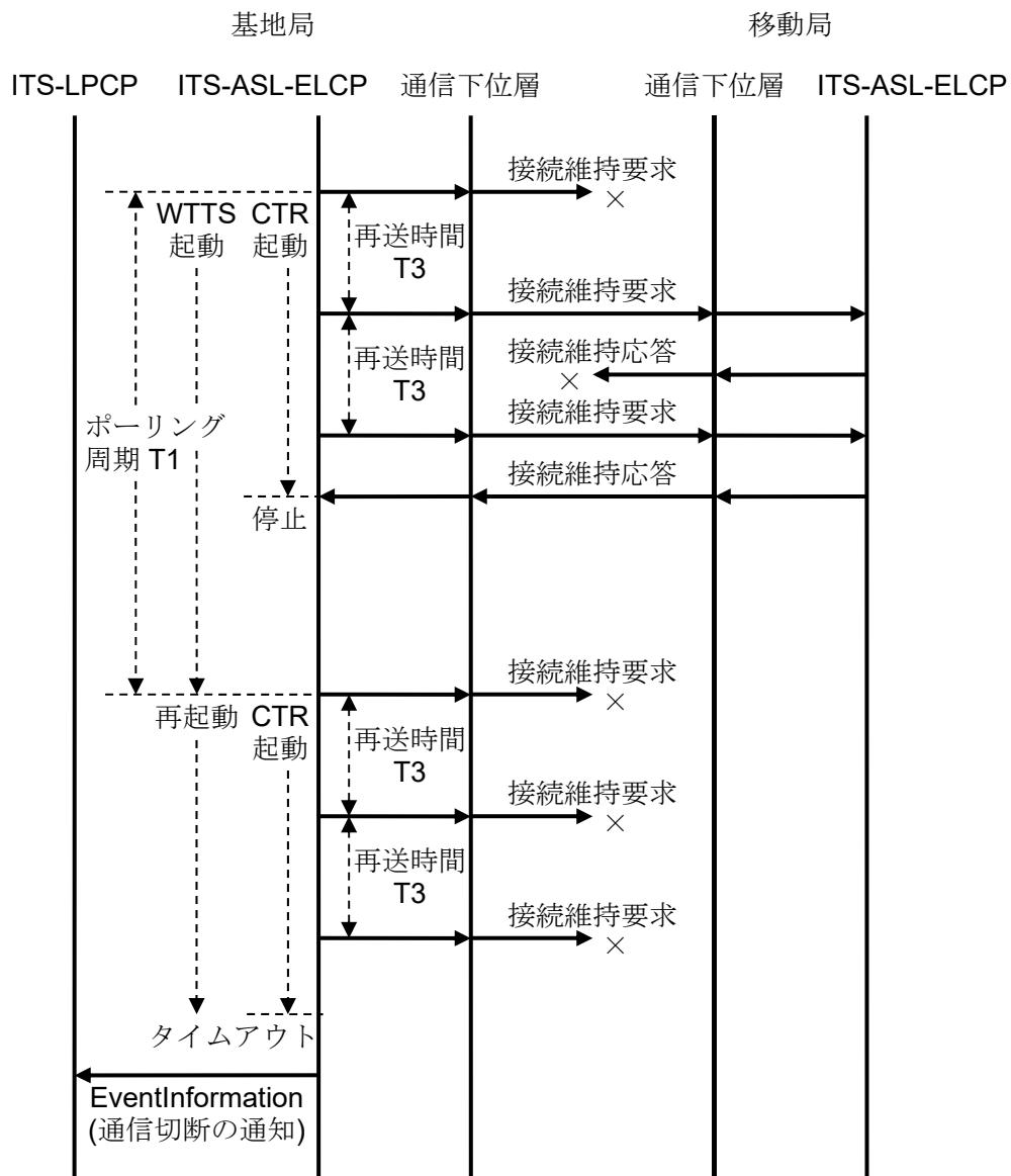
図 3.1-13 接続維持要求の再送制御手順の例
