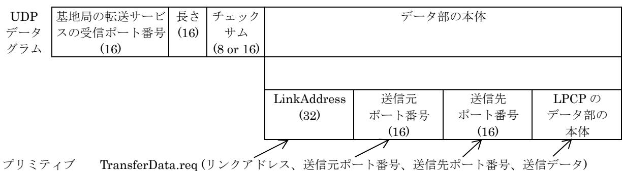
図 3.3-31 TransferDasta.req における PDU マッピング
