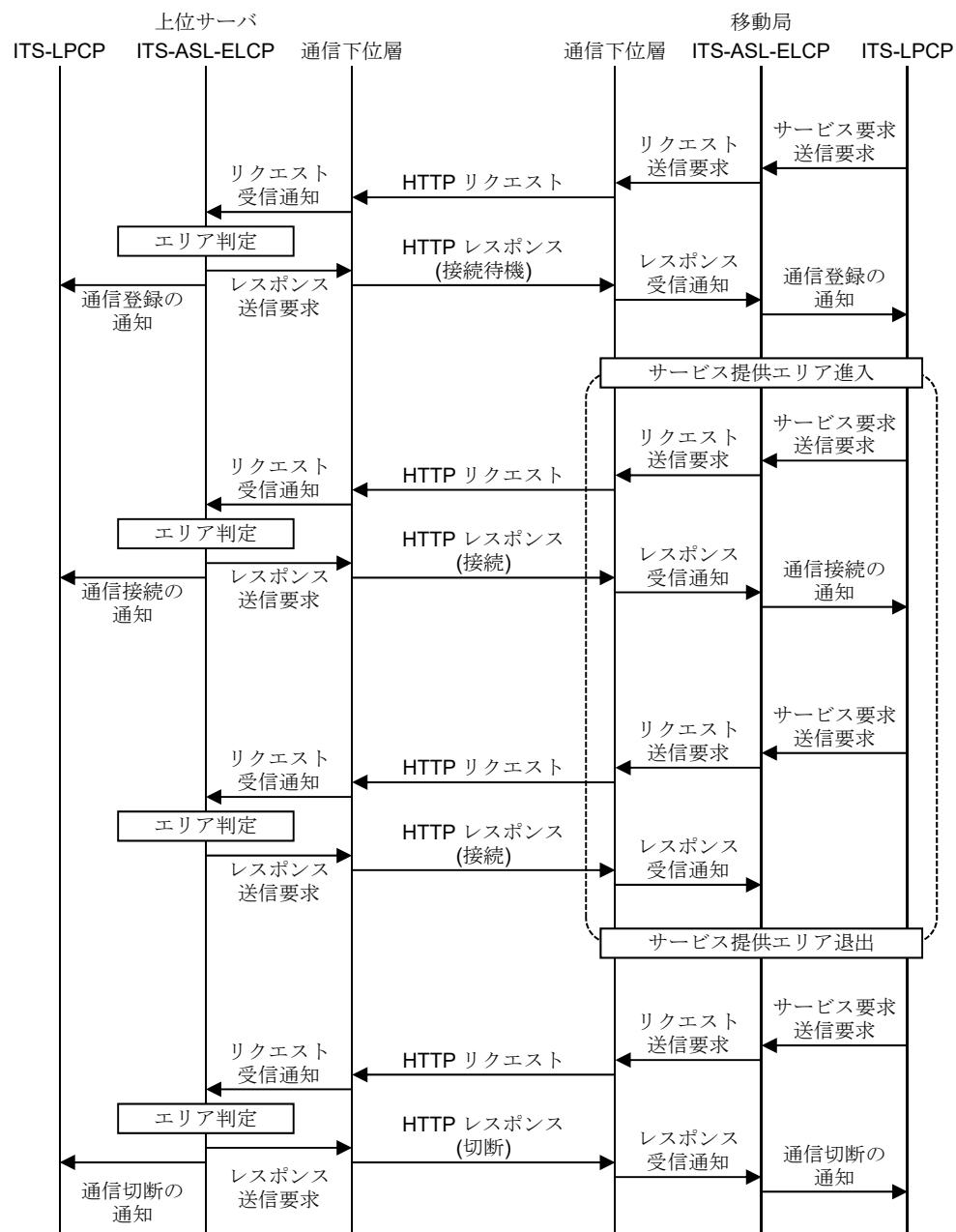
図 3.1-16 通信接続手順の例
