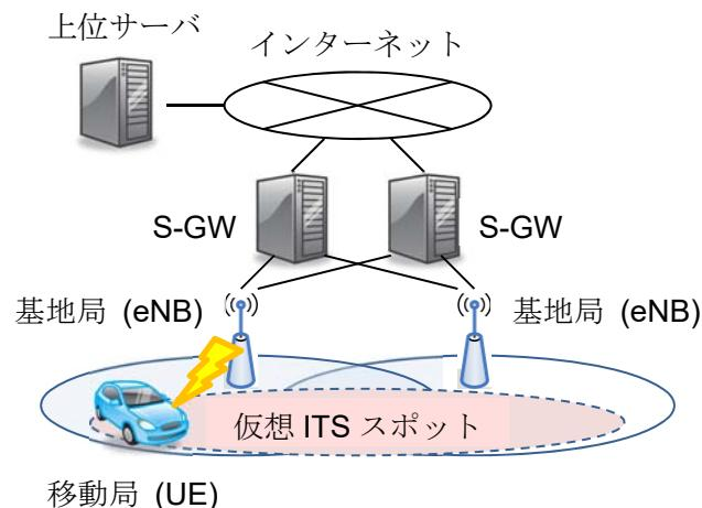
付図 D1-1 LTE-Advanced を使った ITS-ASL の適用イメージ
