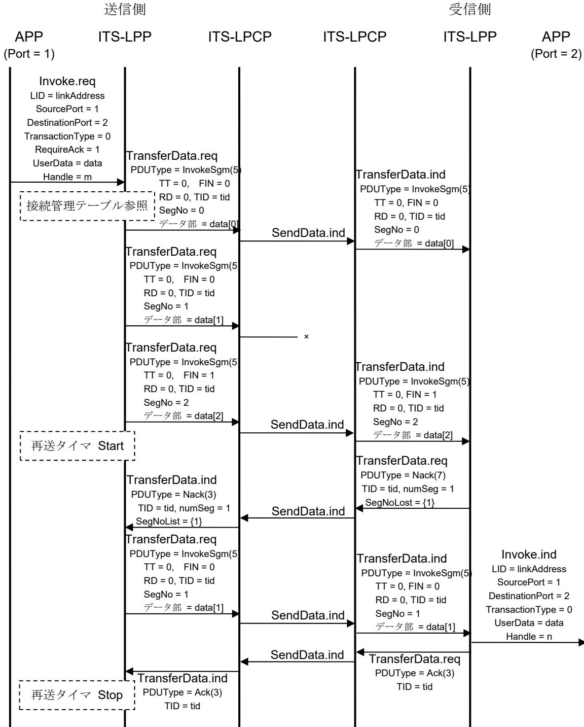
図 3.3-21 分割・組立処理が有効な場合のシーケンス例 (選択的再送処理)
