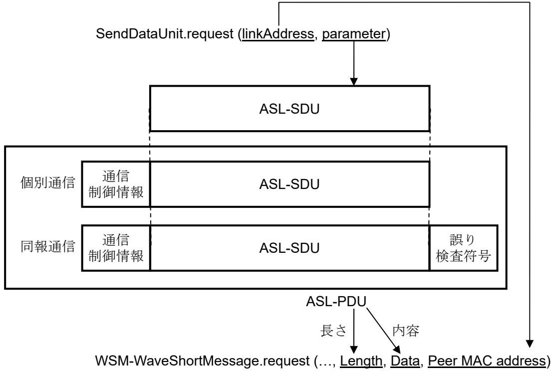
付図 C3-1 `SendDataUnit.request` における下位層プリミティブへのマッピング
