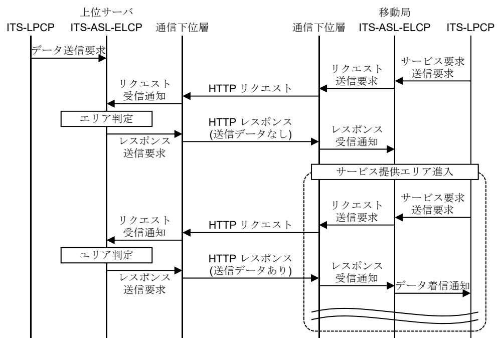
図 3.1-8 上位サーバから移動局への転送サービス処理手順の例
