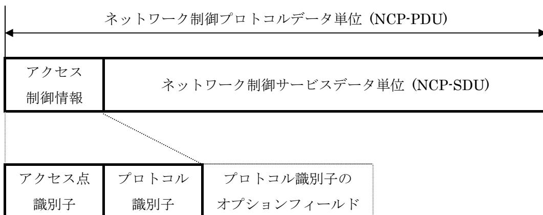
図 3.1-10 通信制御管理の PDU の構成
