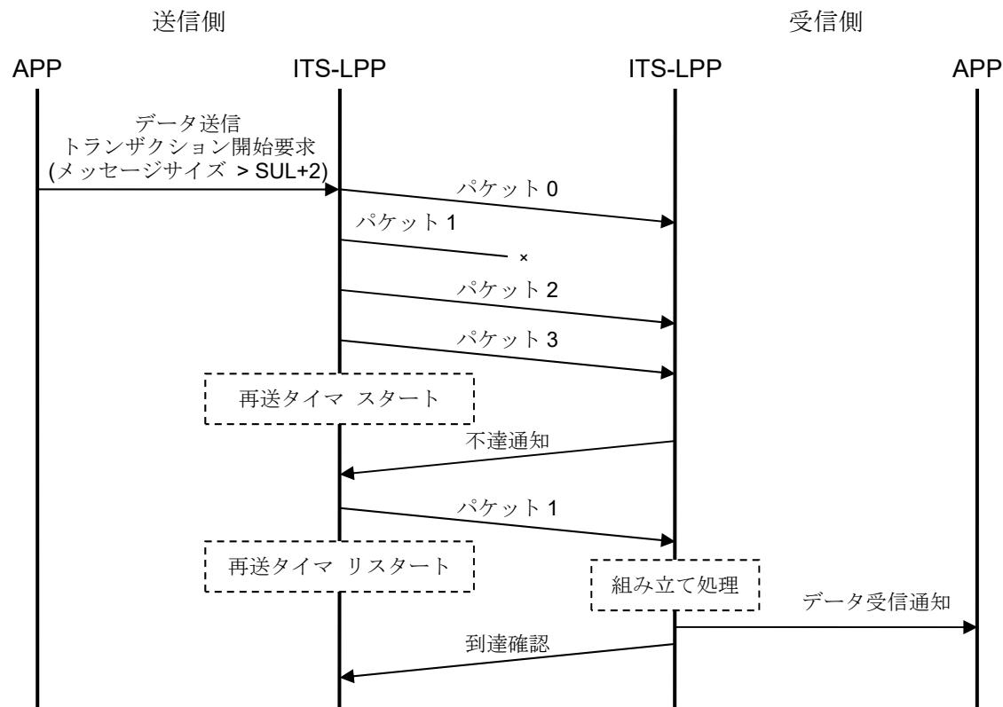
図 3.3-8 選択的再送処理の例
