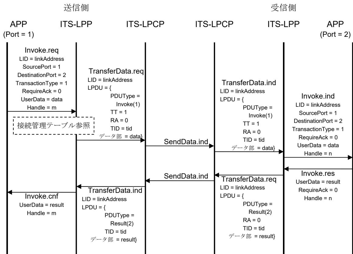
図 3.3-15 リクエスト・レスポンス型トランザクションサービスの基本処理シーケンス例
