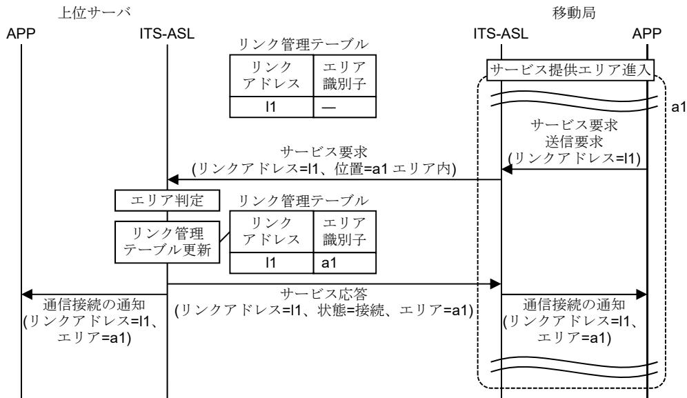
付図 D7-5 通信接続管理手順の例（単一のサービス提供エリアに進入）
