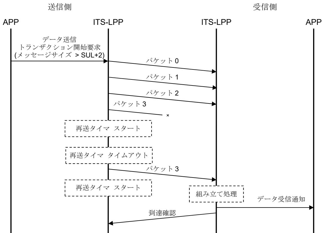
図 3.3-9 最終パケットの再送処理の例
