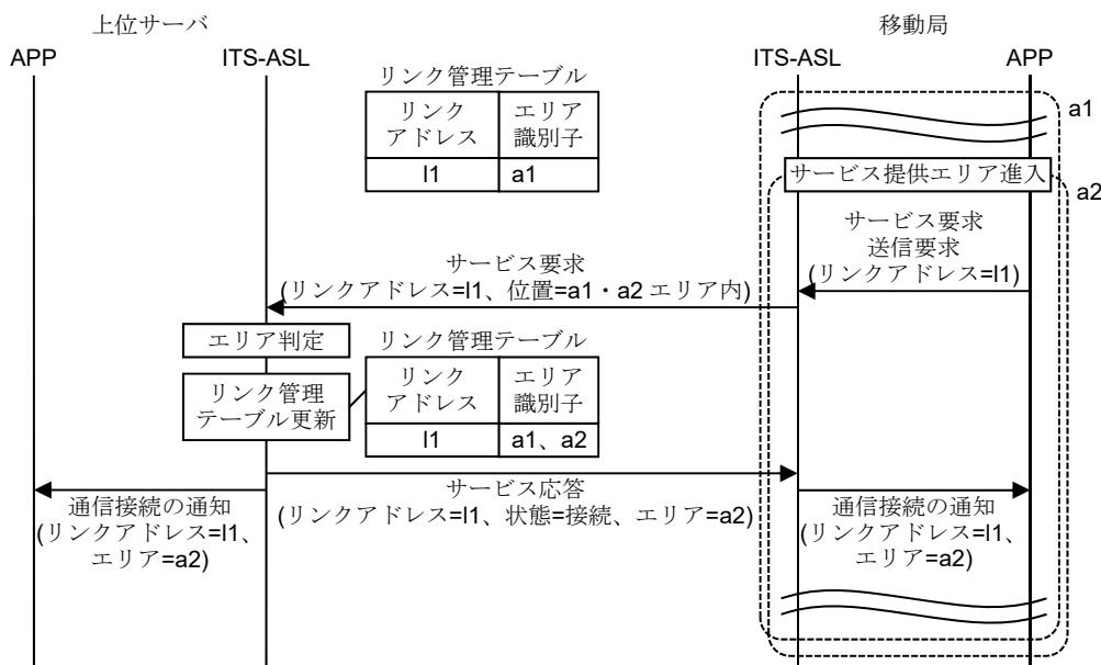
付図 D7-6 通信接続管理手順の例（重なったサービス提供エリアに进入）
