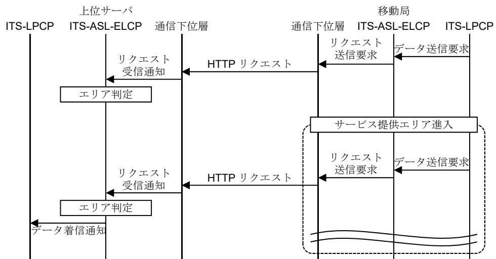
図 3.1-7 移動局から上位サーバへの転送サービス処理手順の例
