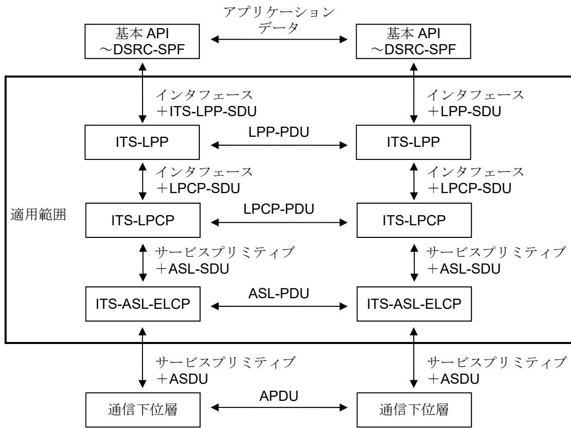
図 2.1-1 ITS-ASL のサービスインタフェースとプロトコルの概観
