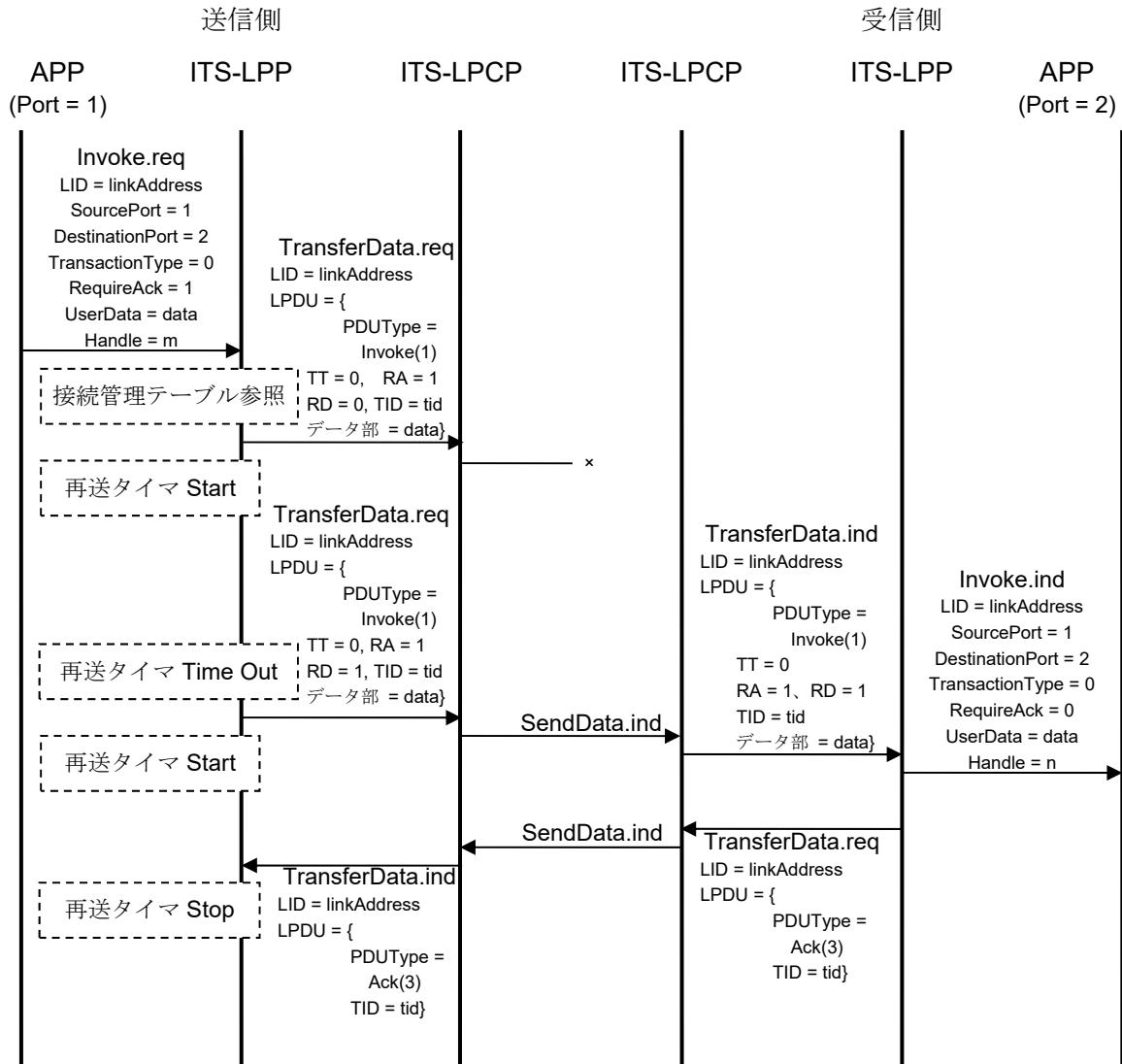
図 3.3-18 再送処理手順（再送成功時）
