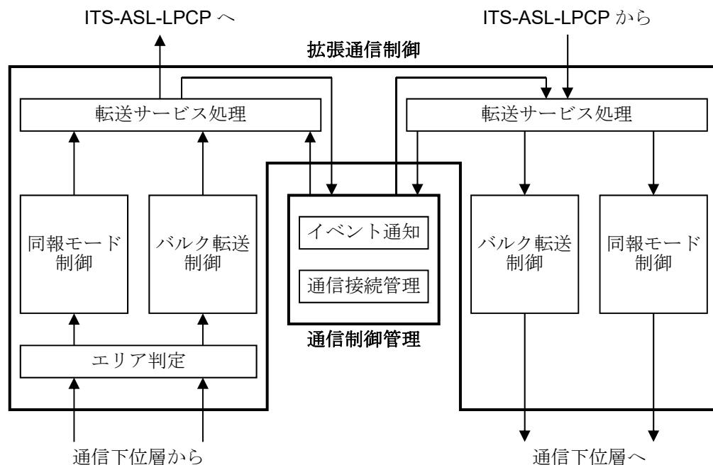
図 3.1-1 上位サーバにおける ITS-ASL-ELCP のエンティティ構成
