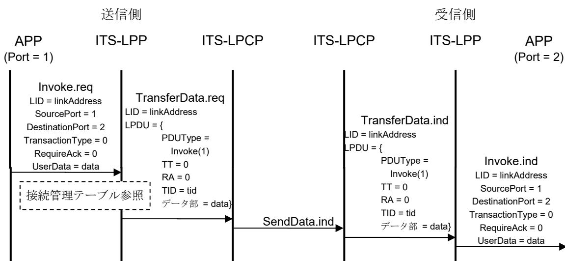
図 3.3-14 データ送信トランザクションサービスの処理シーケンス例
