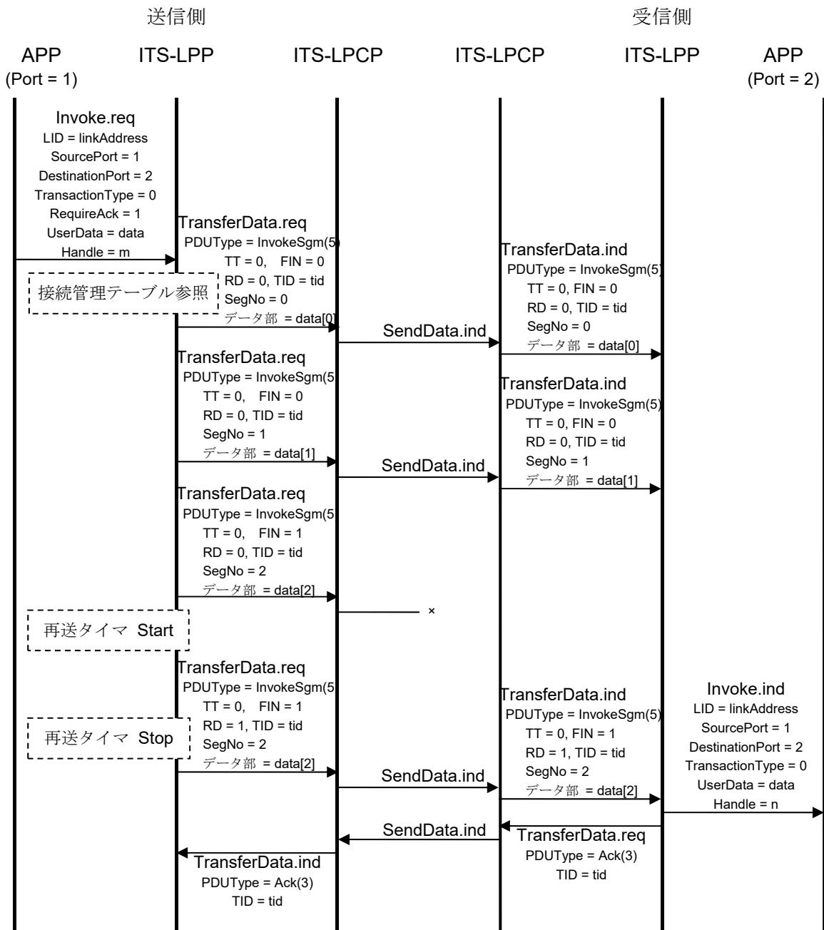
図 3.3-22 分割・組立処理が有効な場合のシーケンス例 (最終セグメントが未達時の場合)
