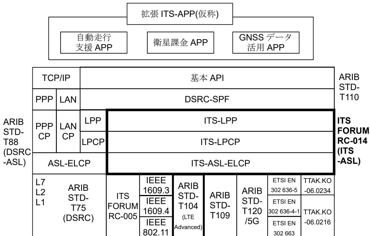
付図 A2-1 DSRC プラットフォーム (拡張) のプロトコル構成
