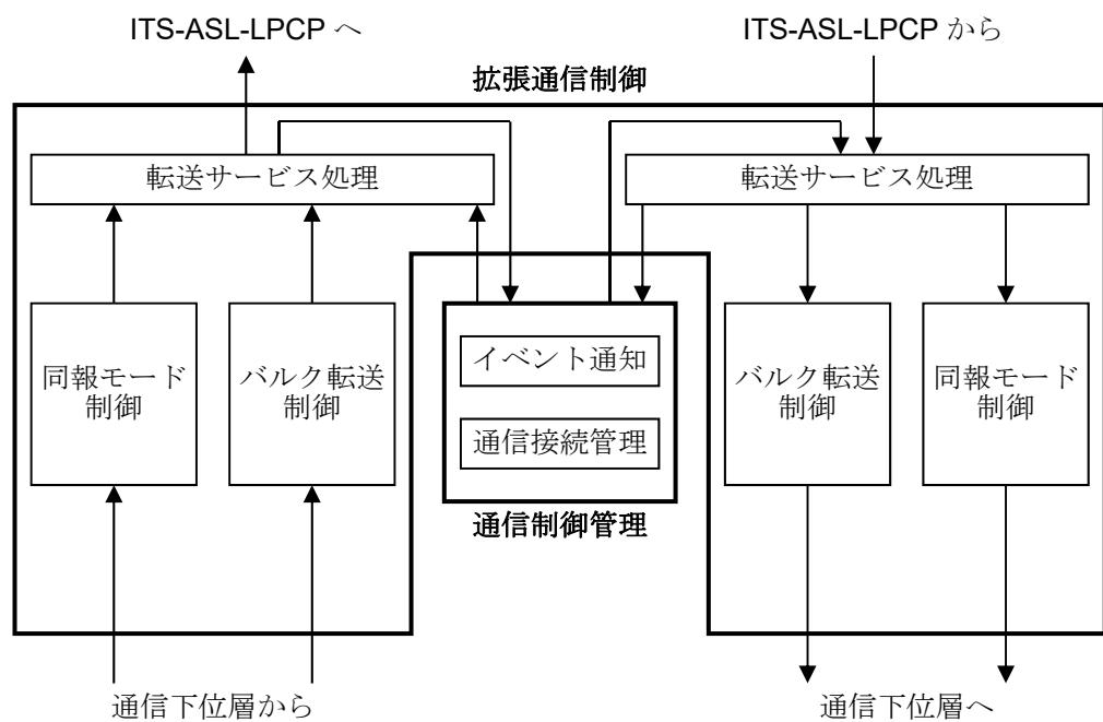
図 3.1-2 移動局における ITS-ASL-ELCP のエンティティ構成
