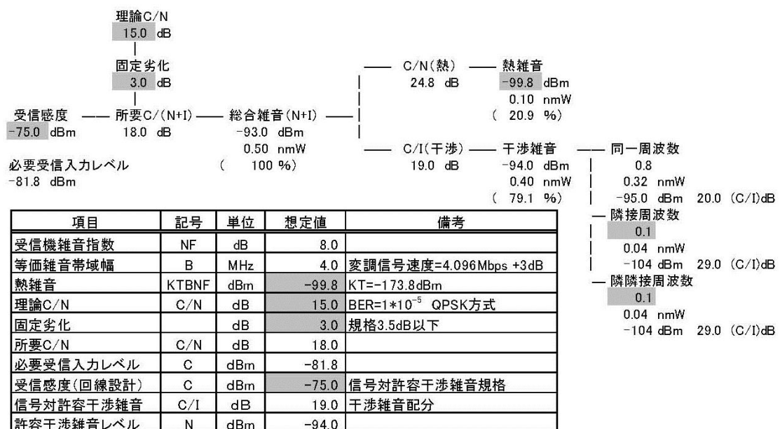
別紙図 7-4 QPSK 方式の受信感度と雑音配分(クラス 2)
