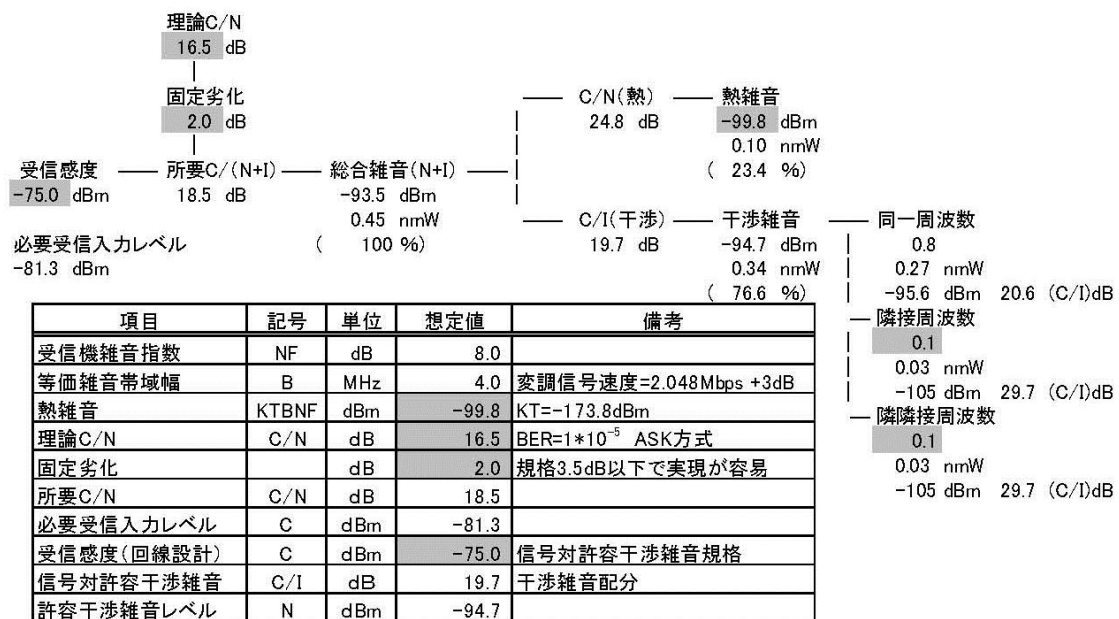
別紙図 7-3 ASK 方式の受信感度と雑音配分(クラス 2)
