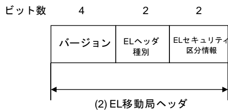
図 3.10 EL 基地局ヘッダと EL 移動局ヘッダの構成
