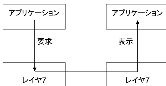
図 4.4-1 レイヤ7とアプリケーション間のプリミティブ種別の関係
