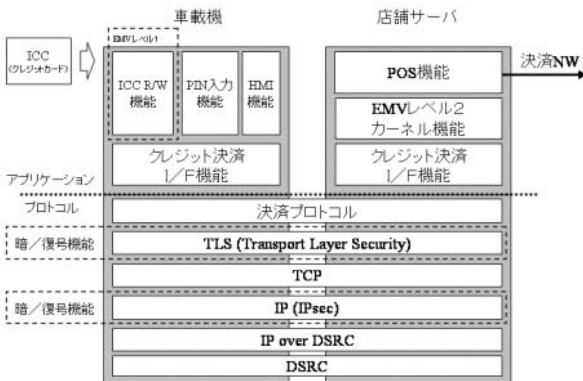
図 6.1.2-1 IP方式のアプリケーション/プロトコルスタック
